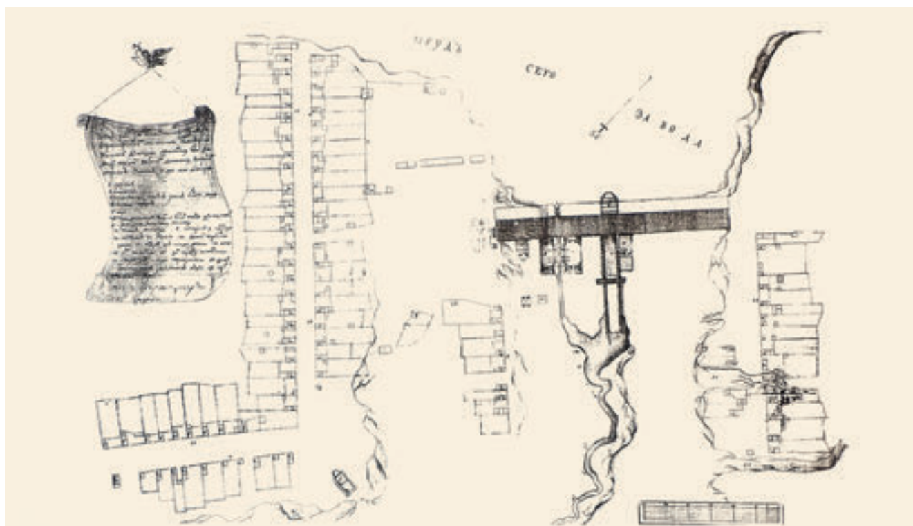
Рис. 7. «Грундрис или основательный чертёж Верхне-Сергинского Демидова железного сво заводу, при оном фабричному домовому и прочему строения значит ниже сего литеры: 1. Церковь; 2. Плотина длинной 105 сажень [220,5 м], шириной 15 сажень [31,5 м]; 3. Вешняный прорез и спуск большой воды длинной 45 сажень [94,5 м]; 4. Ларевый прорез; 5. Ларь длинной 17,25 сажень [36,2 м]; 6. Две молотовые фабрики, в конях по два действующих и одному запасному молоту; 7. Пильная мельница; 8. Слесарная; 9. Кузница; 10. Меховая; 11. Сушяло; 12. Заплат прежнего двора; 13. Амбары для клажи железа; 15. Дом господский; 16. Дом прежний господский; 17. Амбар для клажи провианта; 18. Дома мастеровых и работных людей; 19. Кирпичный сарай. Гиттен-форвальтер Алексей Казачов(?)». (ГАСО, ф. 59, оп. 7, д. 248)
