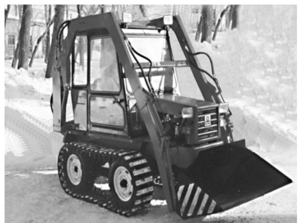
Рис.22 Гусеничный погрузчик на тракторе Т-02
