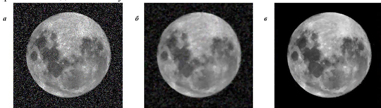
Рис. 11. Сравнение результатов работы медианного фильтра и ОМНМ-фильтра при фильтрации импульсных помех (на примере снимка Луны).
