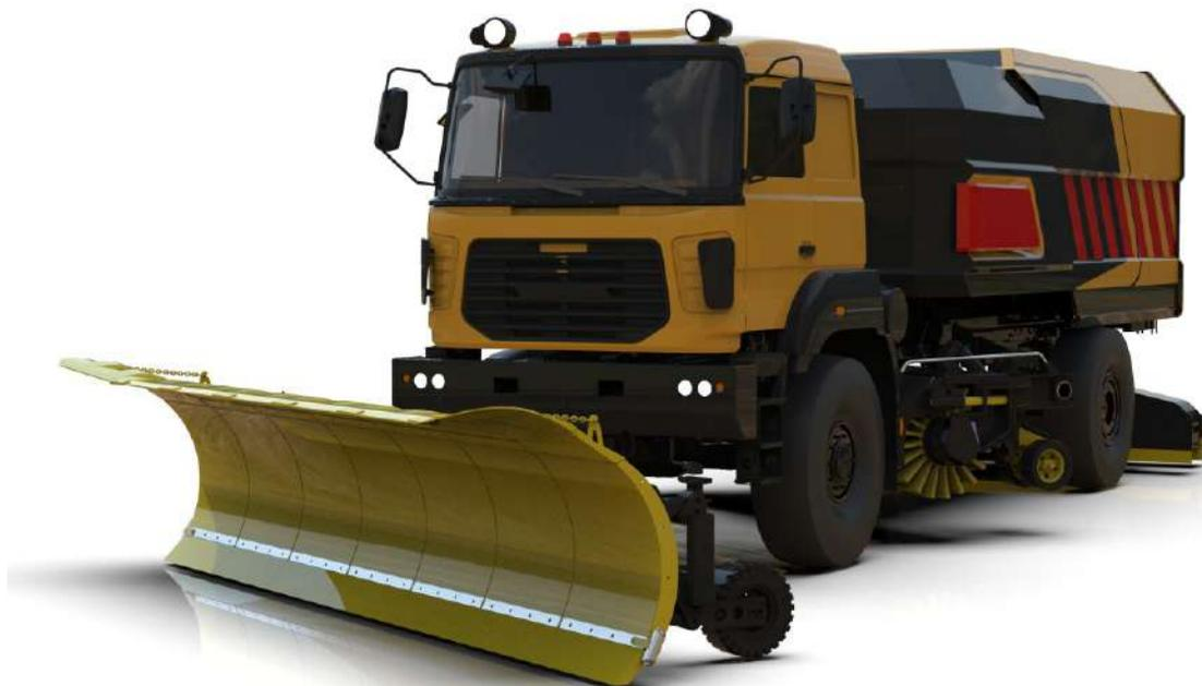
Рис. 1. Аэродромная подметально-продувочная машина
