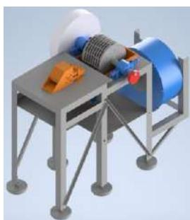
Рис. 1. 3D модель станка для размерного диспергирования отходов кожи
