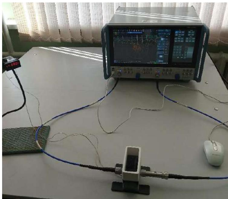
Рис. 1. Установка измерения электродинамических параметров при низких температура
