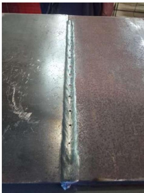
Рис. 3. Образец стыкового сварного соединения с дефектами
