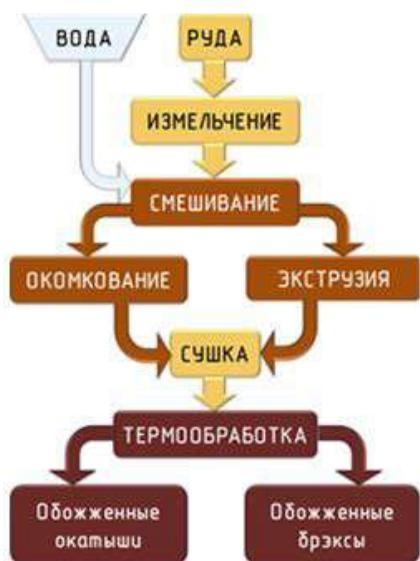
Схема изготовления окатышей и брикетов экструзии (брэсксов)
