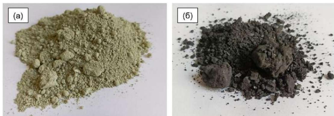
Рис. 1. Вельц-окись (а) и побочный продукт процесса вельцевания (б)
