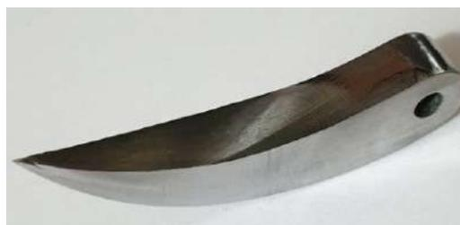
Рис. 5. Инструмент типа «кошачий коготь»
