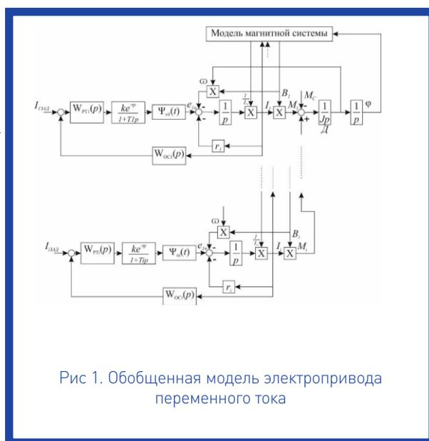
Рис 1. Обобщенная модель электропривода переменного тока
