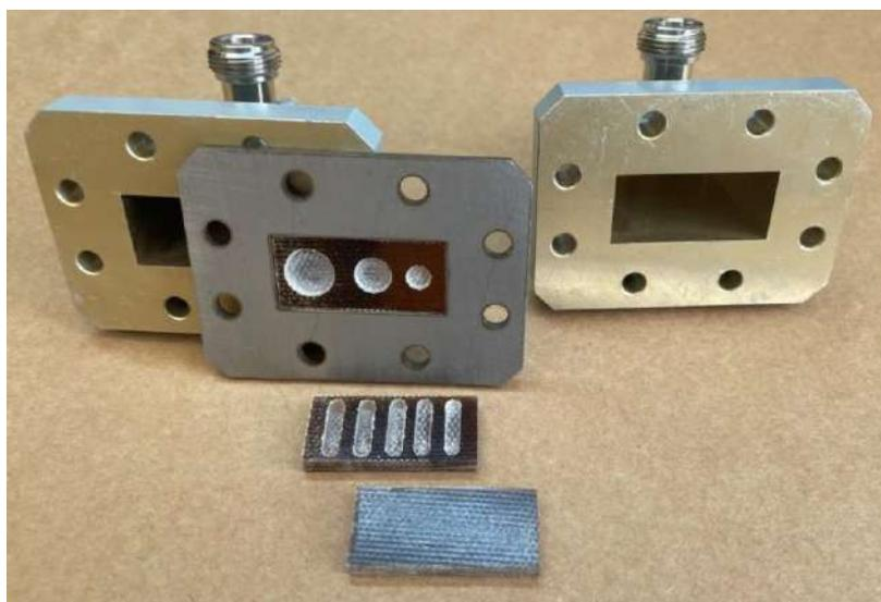
Рис. 2. Каоксиано-волноводный переход с образцами материалов
