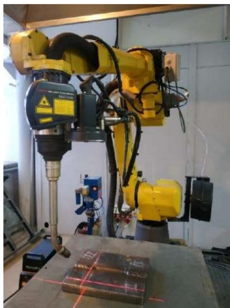
Рис. 1. Сварочный робот FANUC с установленной системой iRVision
